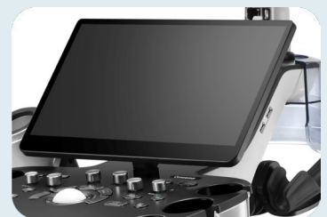
15,6 Zoll Touch Display mit Ges- tensteuerung und einstellbarem Blickwinkel
